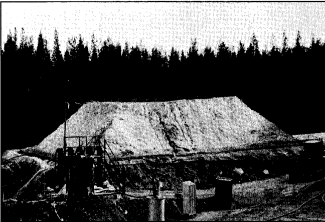
Över anrikningssanden sprids en lakvätska ut som löser guld. Vätskan passerar därefter behållare (tv) med aktivt kol som tar upp guld.
